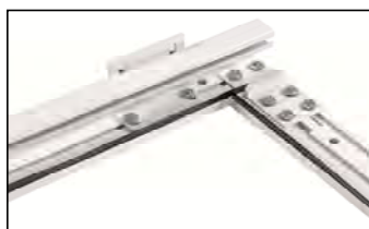
Précadre en alu blanc: Largeur : 80 mm Epaisseur : 7.5 mm Joints EPDM en périphéries Rail de guidage en aluminium laqué blanc
